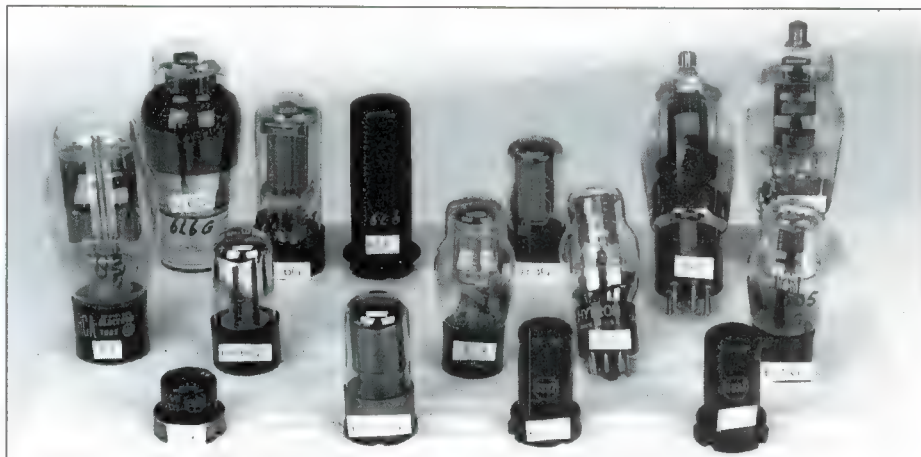
Foto 4: Het buizenoverzicht van de BC 669 met (vlnr) op de achterste rij: drie uitvoeringen van de modulator en Tx oscillator - buizen 6L6 (in de ubular en de stalen uitvoering); de gelijkrichter 5Y3 GT en 2 uitvoeringen van de PA-buizen, de 807 en UK-uitvoering ATS25 met keramische sokkel. Middelste rij: de gelijkrichter type 83; de AF-powerbuis 6K6GT, de Va-stabilisator- buizen OC3 en OD3 en de Rx oscillatorbuis 6J5GT. Voorste rij: de detector 6H6; de HF/IF/AF-buizen 6SK7 (in de ubular en stalen uitvoering) en de mixer 6SA7.
